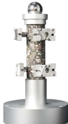
DYNAMIC MODULUS TEST (SMALL DIAMETER) AASHTO TP132
