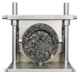
ESSAI D'ADHÉRENCE COUCHE D'ACCROCHAGE/INTERCOUCHE (ESSAI DE CISAILEMENT DIRECT) EN 12697-48 AASHTO TP114
