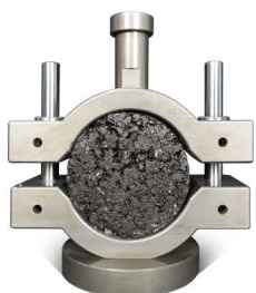
ESSAI DE STABILITÉ MARSHALL
