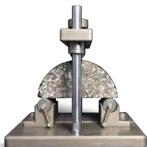
Kit de flexion semi-circulaire (SCB) AASHTO T393, ASTM D8044
