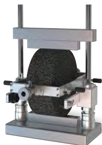
Kit de fatigue en traction indirecte EN 12697-24, méthode F
