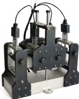
Montage de flexion quatre points AASHTO T321, JTG E20-T0739 Jauge d'étalonnage (entraxe 119 mm) et bloc 63,5 × 50 × 380 mm
