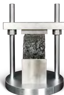
Kit d'orniérage idéal (IRT) ASTM WK71466, ASTM D8360
