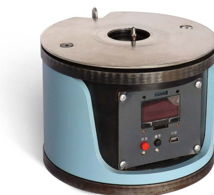
HYBD-2 - dispositif d'étalonnage de l'angle interne (option)
