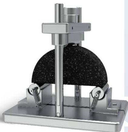
Dispositif d'essai de flexion semi-circulaire (SCB)
