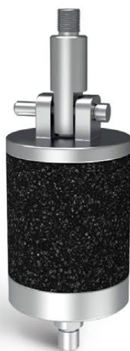
Dispositif d'essai d'adhérence de couche d'accrochage (traction)
