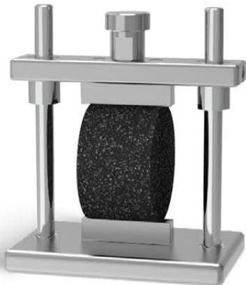
Dispositif d'essai de traction par fendage
