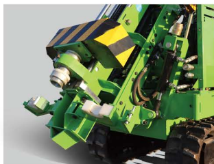
Mouton de base de 10 kg et masses supplémentaires de 20 + 20 + 13,5 kg.
