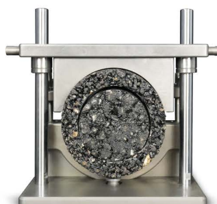
UNIÓN DE CAPA ADHERENTE/INTERCAPAS PRUEBA DE RESISTENCIA (PRUEBA DE CORTE DIRECTO) EN 12697-48 AASHTO TP114
