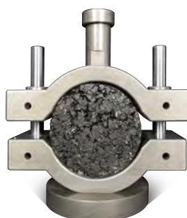
Plantilla de prueba de estabilidad Marshall JTG E20 T0709
