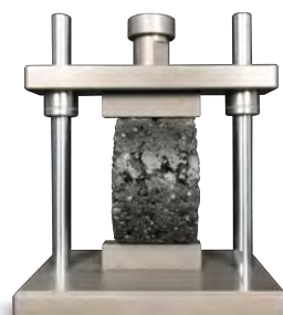
Kit de prueba de división por tracción JTG 3410 T0716
