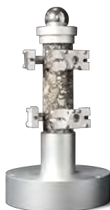
Conjunto de plantillas de módulo dinámico (tamaño pequeño) AASHTO T132
