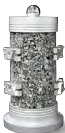
Conjunto de plantillas de módulo dinámico AASHTO T378, JTG E20-T0738 Incluye 18 abrazaderas y 60 pines de posicionamiento.
