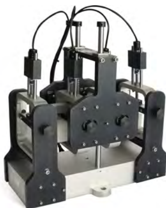
◀ Juego de plantillas para doblar en cuatro puntos AASHTO T321, JTG E20-T0739 Incluye un medidor de calibración (distancia entre centros: 119 mm) y un bloque de calibración (63.5×50×380 mm).
