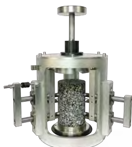
Muestra de prueba de módulo dinámico dispositivo auxiliar de preparación
