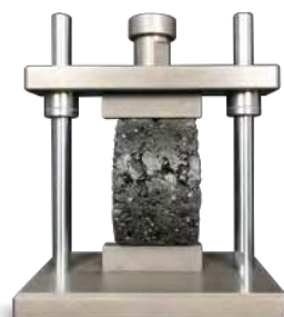
Комплект испытания на раскалывание JTG 3410 T0716
