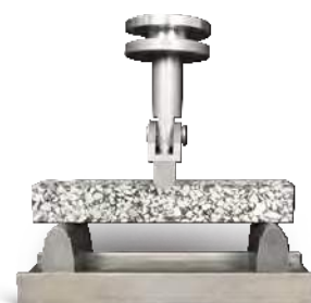
Комплект испытания на изгиб JTG E20 T0715
